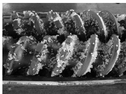
图4 丁基橡胶氯化挤出时螺杆内的丁基橡胶
